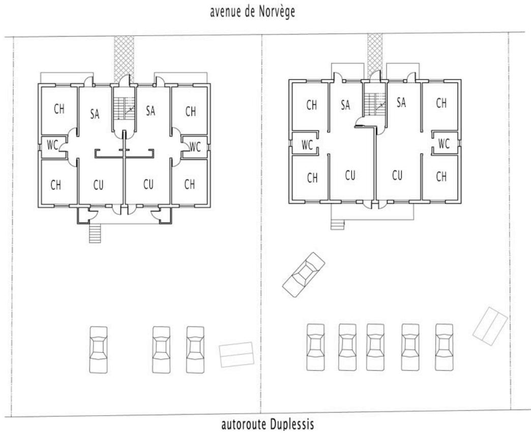
Figure 51. Plan du rez-de-chaussée d'un walk-up existant.
